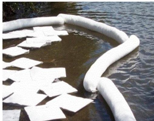
Figura 2: Material absorvente.
