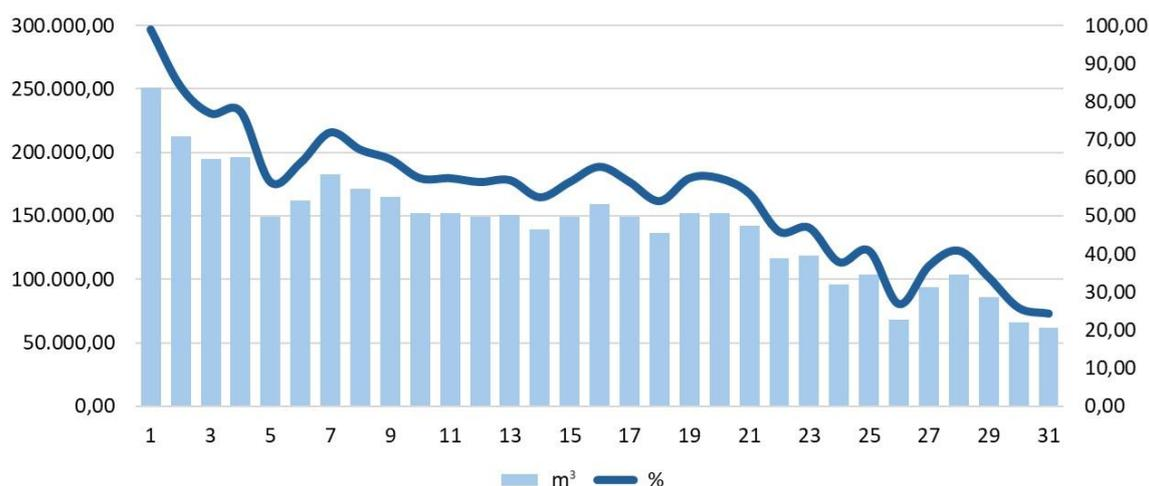
*Figura 51: Volume de óleo em superfície ao longo do período da simulação e respectivos percentuais em relação ao volume do vazamento (ENAUTA, 2022).*
