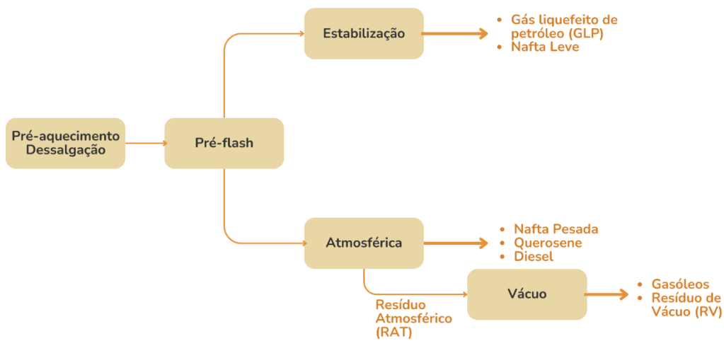
Figura 3 - Diagrama de Blocos da Destilação Atmosférica
