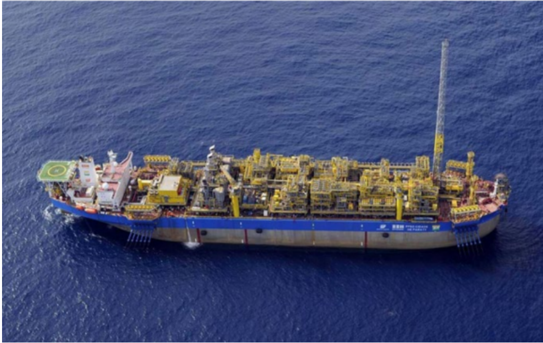
Figura 4: Plataforma FPSO. Fonte: FGV Energia, 2022
