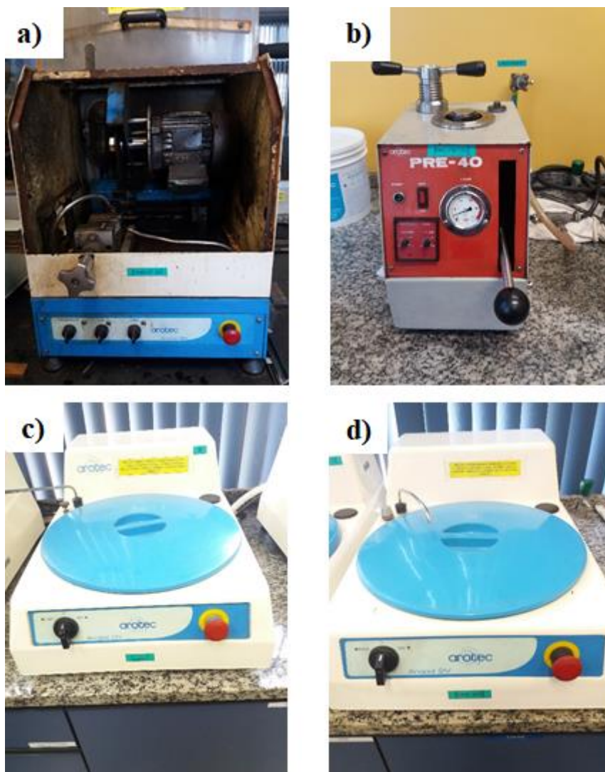
Figura 29: Preparação metalográfica; a) Máquina de corte; b) Embutidora; c) Lixadeira; d) Politriz.
