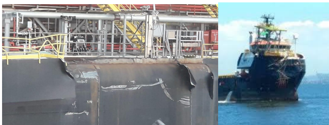
Figura 4.5 - Imagens após a colisão de um navio de apoio com a plataforma P-77 no Brasil, em 2020
