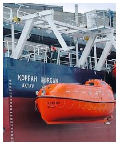
Figura 4.18 - (A) Baleeira do tipo "queda-livre". (B) Baleeira sendo lançada ao mar por turco de içamento
