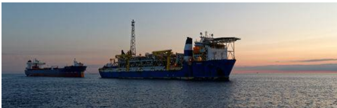
Figure 4.6 - Operação de offloading
