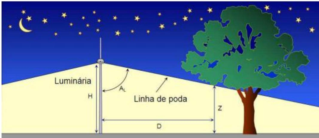
Figura 5.6 - projeção da desobstrução longitudinal [11]
