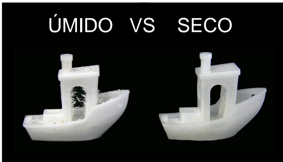
Figura 1.1 - Diferença no acabamento da peça impressa com filamentos úmidos e secos.
