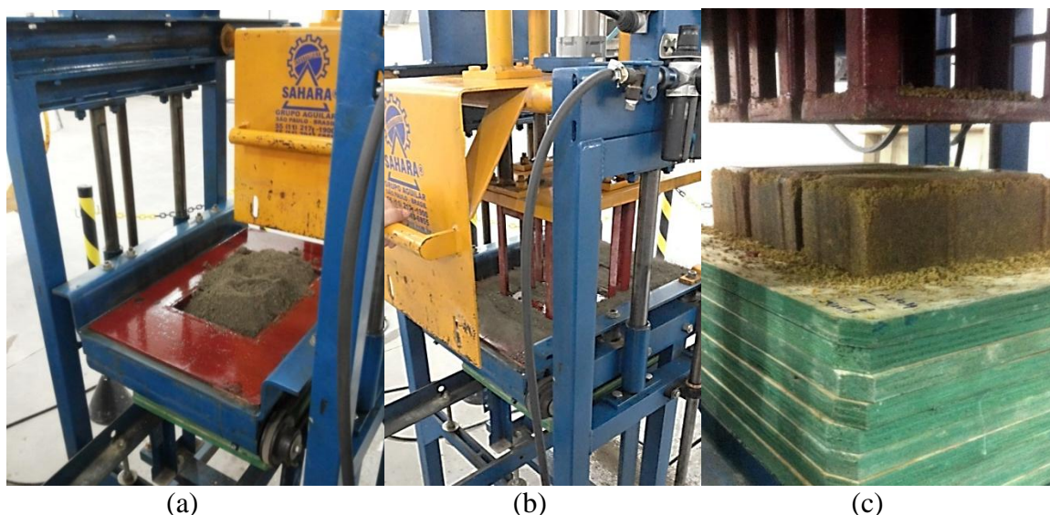
Figura 17 – (a) Lançamento do concreto seco, (b) Vibro-compressão do concreto e (c) Desmoldagem dos corpos-de-prova.
