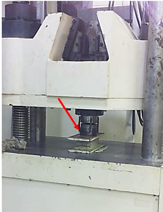
Figura 18 - Ensaio de compressão axial com destaque para o uso de placas auxiliares.
