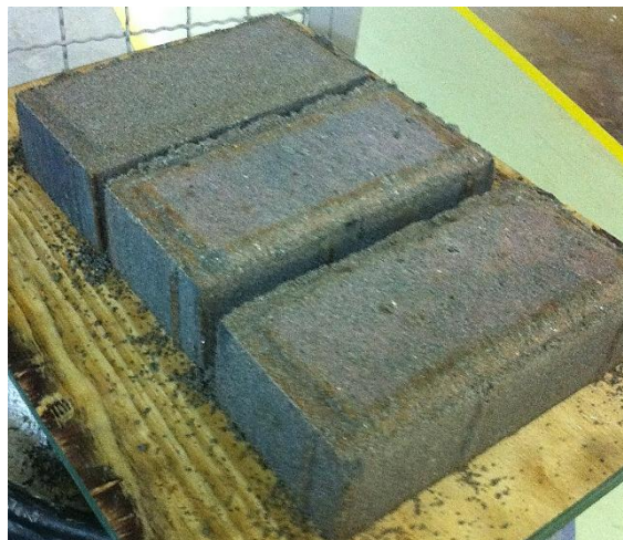
Figura 16 – Blocos de concreto produzidos na vibro prensa (20 x 10 x 6 cm).
