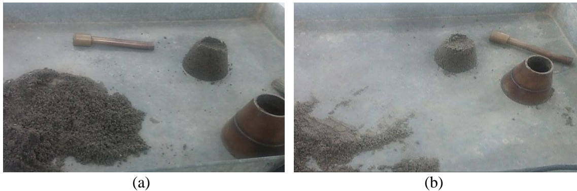
Figura 10 – (a) e (b) Amostra de agregado após a retirada do molde metálico, antes de atingir a condição de saturado superfície seca
