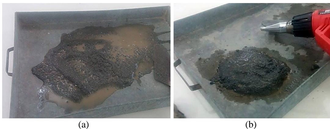
Figura 9 – (a) Amostra de agregado após ser deixada coberta com água por 24 horas e (b) Amostra de agregado sendo submetida à ação de uma suave corrente de ar quente.
