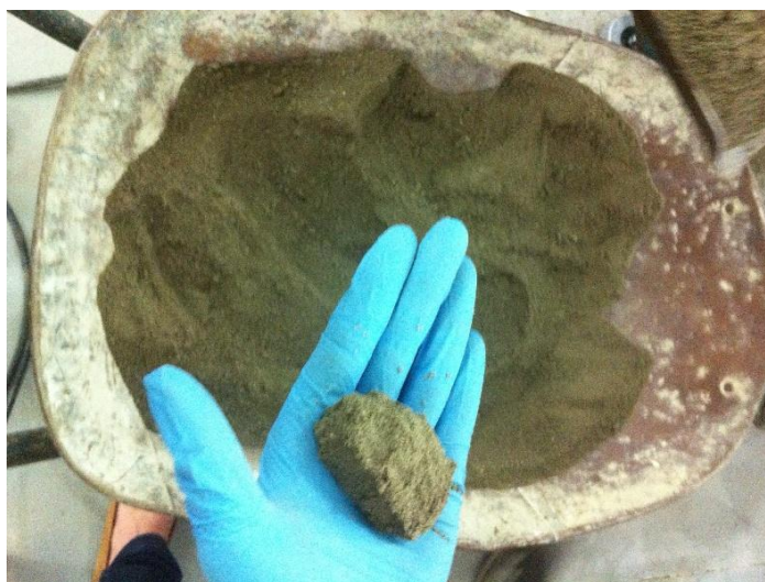
Figura 14 - Consistência adequada da mistura de concreto seco - Ponto de Pelota
