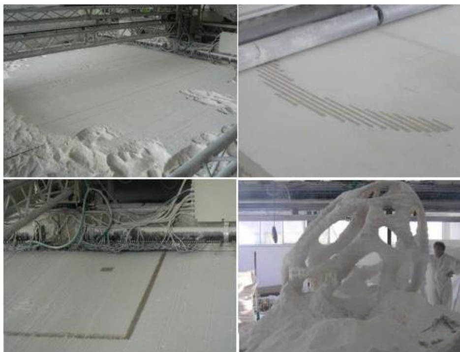
Figura 12- Procedimento de produção D-Shape (Dini, 2009).
