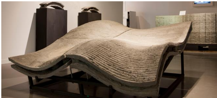
Figura 11– Estrutura feita através do Concrete Printing. Fonte: (LBORO, 2015).
