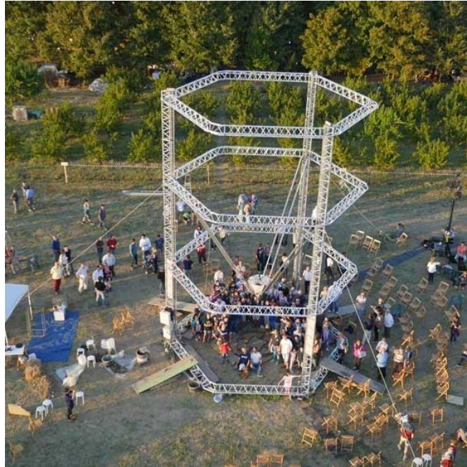
Figura 22- A impressora Bigdelta. Fonte: (3dwasp, 2012).
