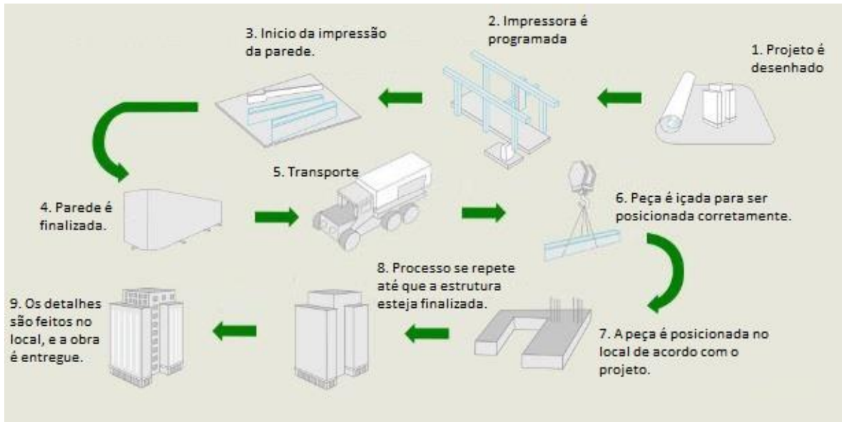
Figura 24- Metodo de produção da WISUN. Fonte: (WISUN, 2018).
