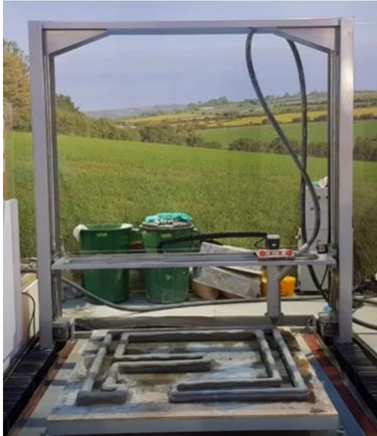
Figura 26-Impressora da Inovahouse3D em atuação. Fonte: (Inovahouse3D, 2019).
