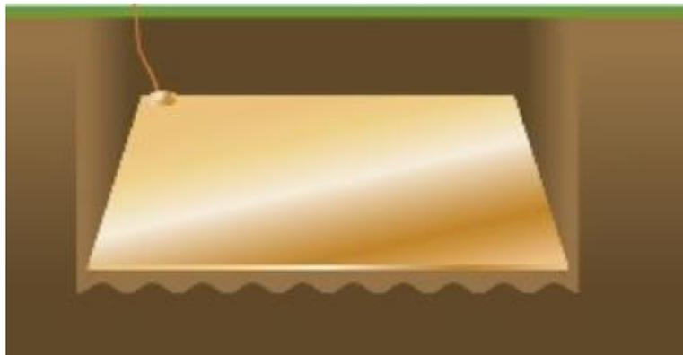
Figura 3.9:Placa condutora enterrada no solo - Fonte: Blog do Portal Eletrodomésticos [19]
