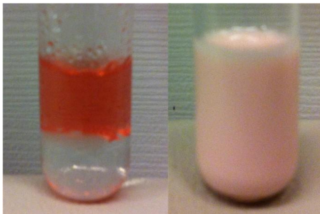
Figura 2.1.5. Representação do sistema diesel + água + surfactante antes da agitação e do sistema diesel + água + surfactante após a agitação. Fonte: Laboratório de Tecnologia Submarina (LTS).
