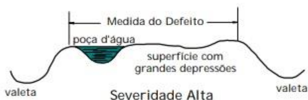
Figura 8– Exemplo de Seção Transversal com severidade alta (ODA, 1995).
