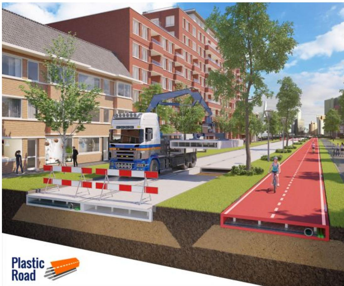
**Figura 11:** Imagem conceitual do projeto *PlasticRoad*. É possível observar a facilidade da construção e manutenção com a estrutura modular, e as possíveis aplicações ao utilizar o interior da estrutura [35].
