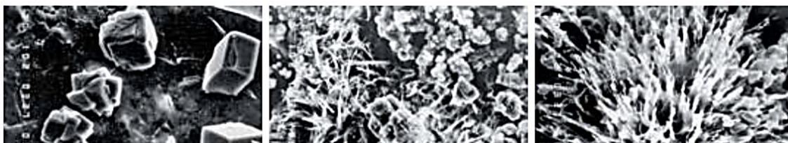
Figura 13 - Etapas de cristalização. Fonte: MC-BAUCHEMIE (2013)
