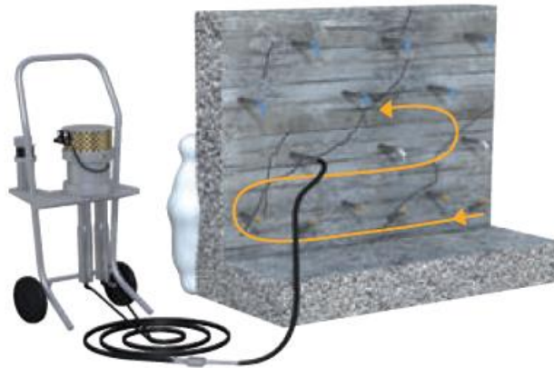
Figura 65 - Injeção a partir da fileira mais baixa de furos. Fonte: SIKA (2015)
