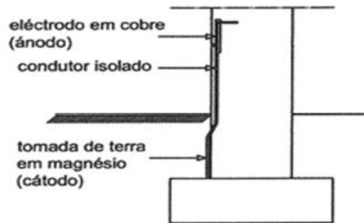
Figura 69 -Eletro-osmose semi-passiva. Fonte: TORRES (2014)
