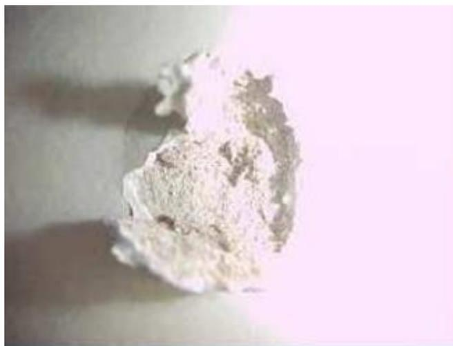
Figura 42: Vesículas na argamassa de revestimento. Fonte: ABCP, 2006.
