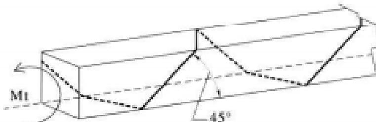
Figura 14: Representação esquemática da fissuração devido ao esforço de torção diagonal. Fonte: Helene, 2003.
