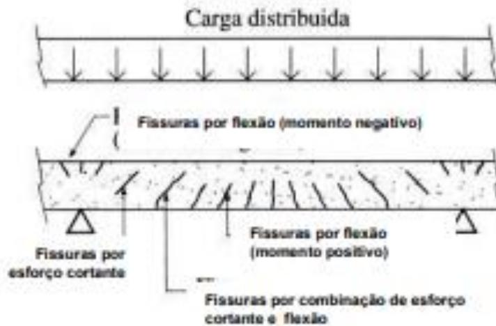
Figura 13: Representação esquemática das patologias observadas em vigas de concreto armado com fissuração devido ao esforço cortante e flexão. Fonte: Helene, 2003.
