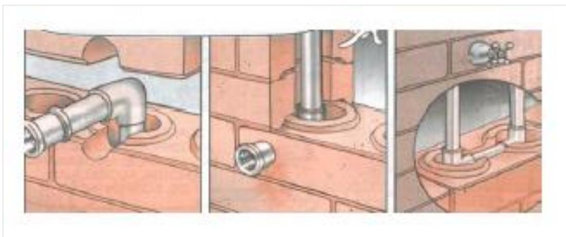
Figura 3:: Detalhe das instalações hidráulicas.
