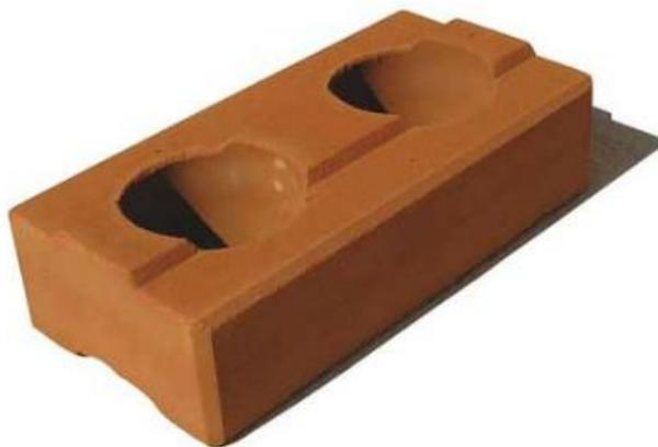
Figura 22: Tijolo solo-cimento compactado.
