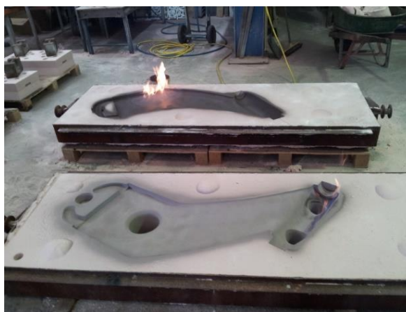
Figura 11 – Molde para fundição de Pé de Galinha. Fonte: Imagens Internet
