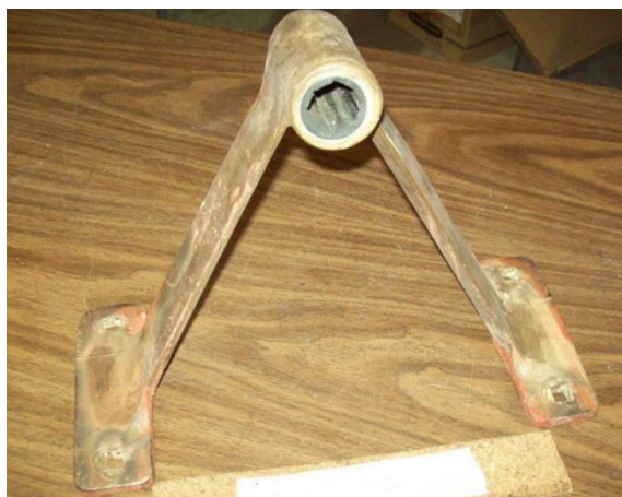
Figura 28 – Suporte “V” com palma, aparafusado e soldado direto ao casco. Fonte: Imagens Internet
