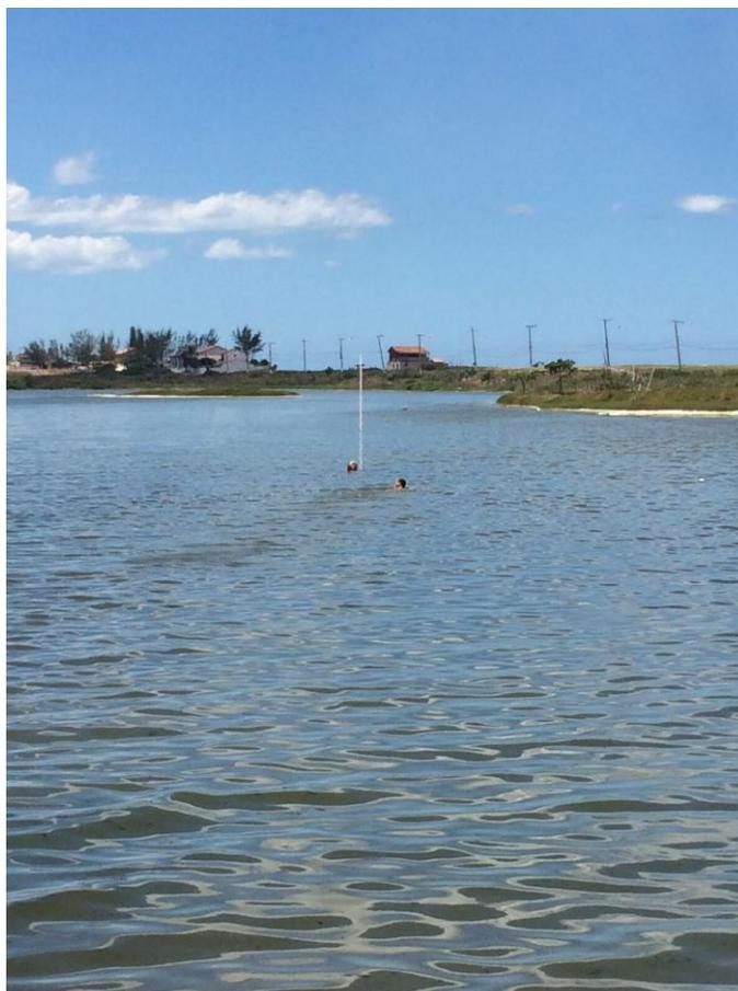
**Figura 19:** Registro do processo de coleta de dados topo-batimétricos para elaboração dos perfis. Na foto, utilização da mira em medições dentro da Lagoa da Barra para criação do corte Lagoa (acervo pessoal).
