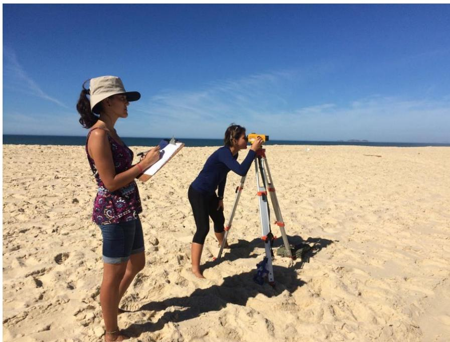
**Figura 15:** Registro do processo de coleta de dados topo-batimétricos, com utilização do nível óptico, para elaboração dos perfis (acervo pessoal).
