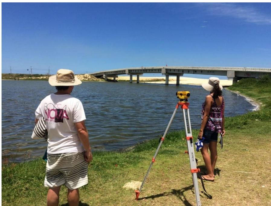
**Figura 18:** Registro do processo de coleta de dados topo-batimétricos para elaboração dos perfis e análise da área de estudo. Na foto, pode ser observada a vista da margem esquerda da Lagoa da Barra (acervo pessoal).
