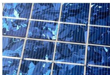
Figura 4 – Detalhe de uma Célula Fotovoltaica de Silício Policristalino [7]
