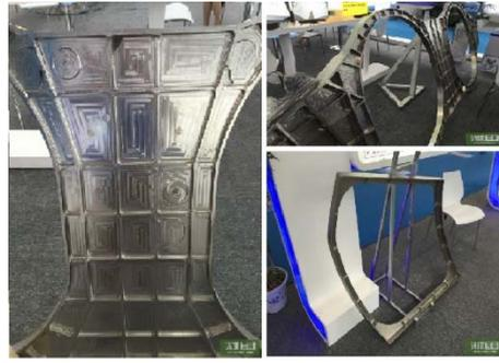
Figura 8 - Peças de aeronaves impressas 3D. Fonte: HIPOLITE (2015)
