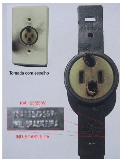
Figura 2.5: Tomada de corrente submetida a uma sobrecarga [6]
