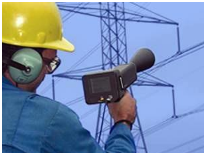
Figura 3.35: Uso do ultrassom para detectar arcos e faiscamentos [34]
