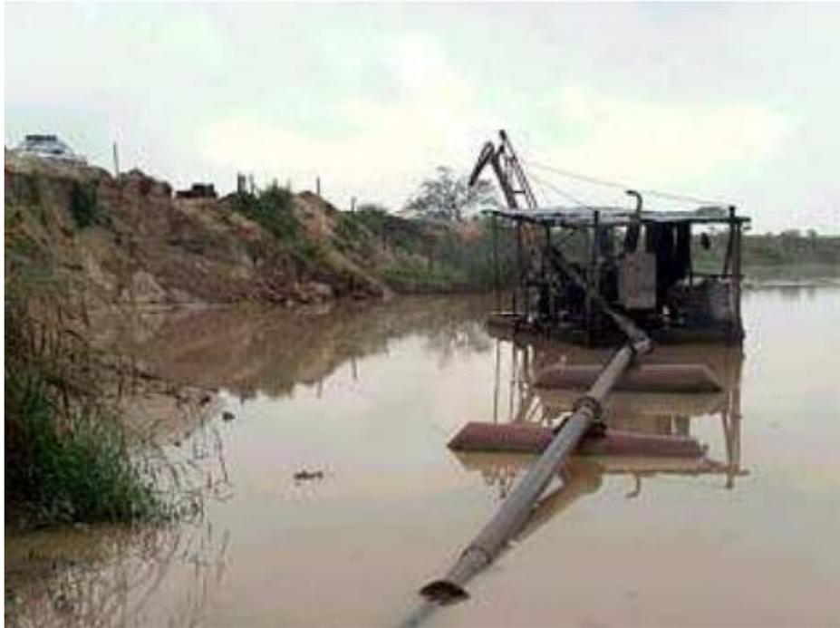
**Figura 11 - Margem desmatada e assoreamento do rio devido à extração de areia**
