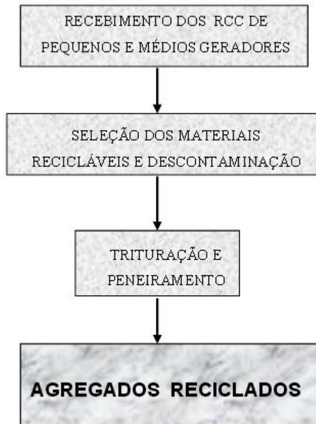
Figura 19 - Processo de reciclagem dos RCD
