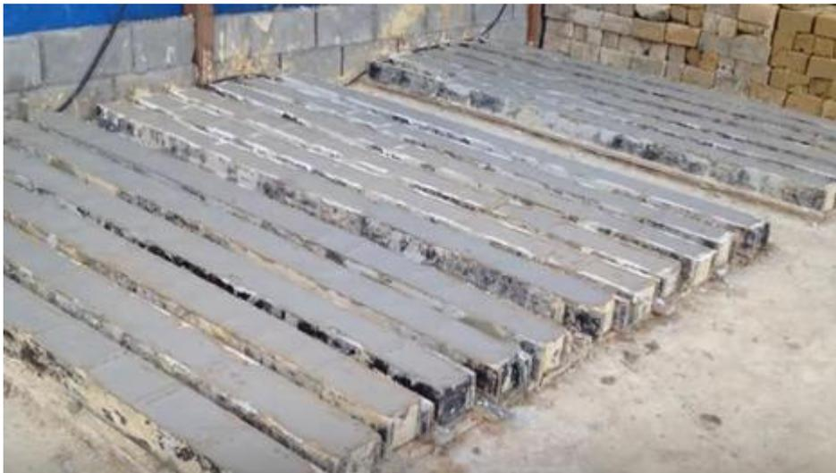
**Figura 29 - Formas para fabricação dos tijolos**
