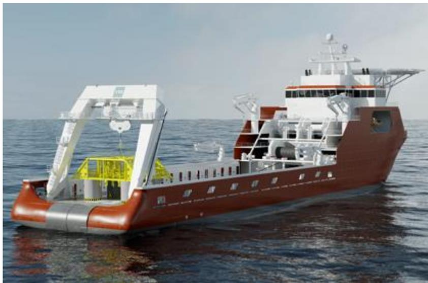
Figura 3.22 - Navio tipo AHTS com A-Frame
