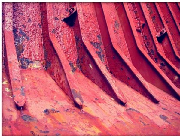
Figura 2.8 - Chapeamento e reforçadores com corrosão
