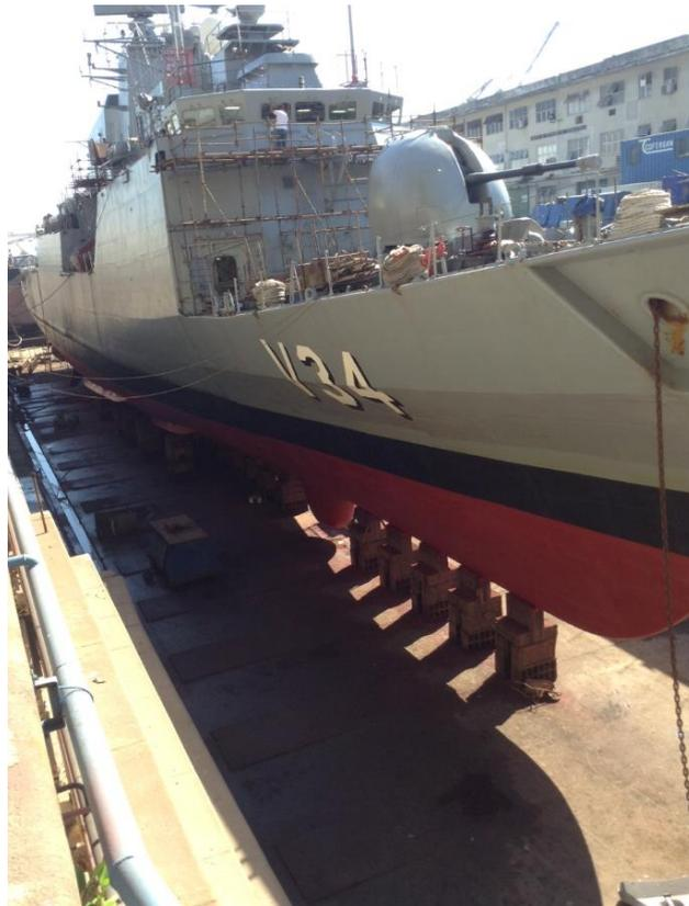
Figura 3.5 - Detalhe da docagem da corveta "Barroso", no dique seco "Alte Jardim", mostrando apêndice no casco posicionado entre picadeiros
