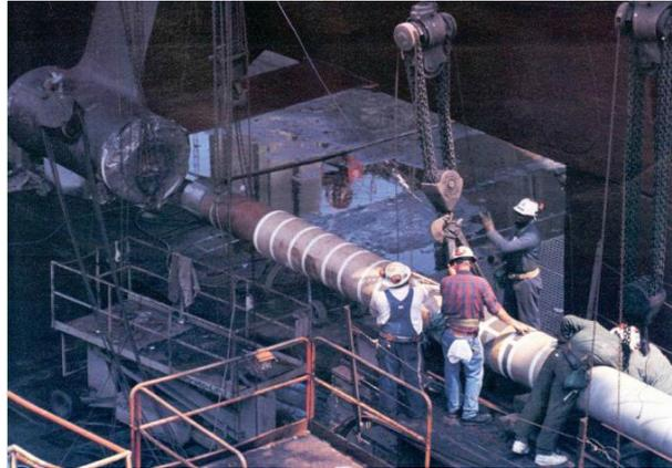
Figura 2.6 - Retirada de eixo propulsor
