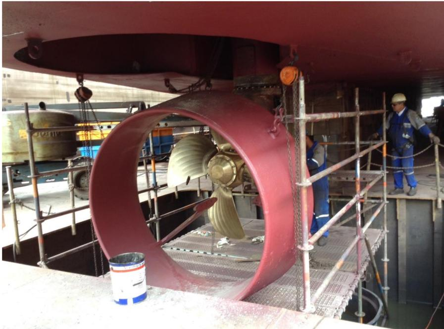
Figura 3.9 - Piscina para retirada de propulsores e apêndices - "Dockshore I"
