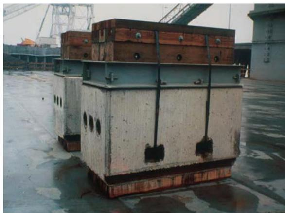
Figura 5.1 - Picadeiro de concreto e madeira
