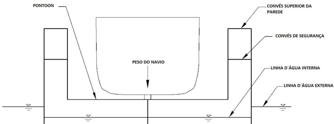
Figura 4.4 - Esquema de um dique flutuante
