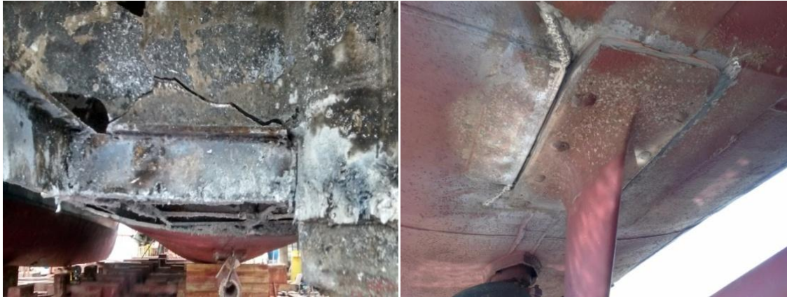
Figura 13: Avarias na Região de Popa (Fonte: CCR Barcas)
