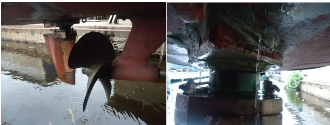
Figura 12: Região de Popa em condição crítica (Fonte: CCR Barcas)
