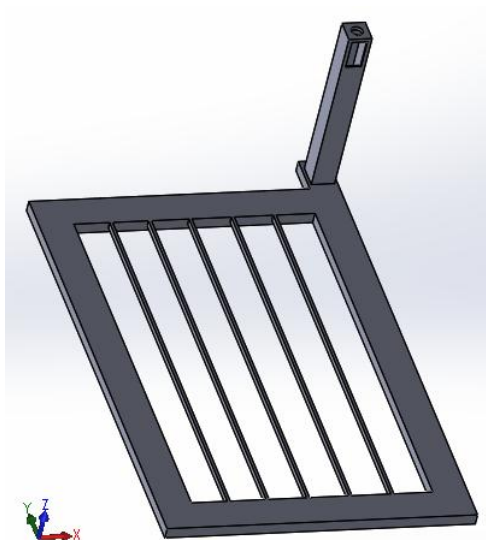
Figura 42 – Esboço da Base da Plataforma
