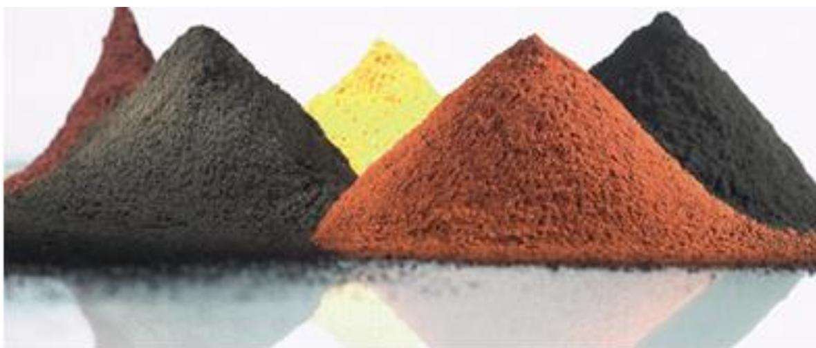
Figura 17 - Diferentes tonalidades de pigmentos utilizados em concretos na forma de pó.
