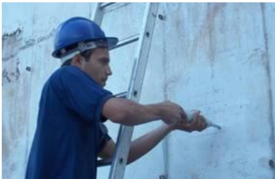
Figura 31: Identificação dos pontos e disparo contra a superfície (FONTE: O autor)
