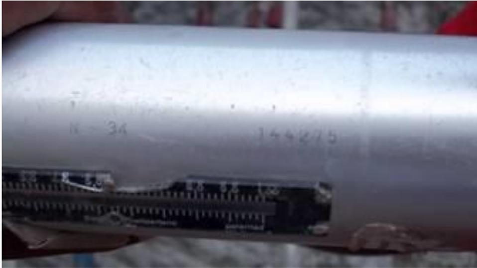
*Figura 32: Esclerômetro utilizado nos ensaios (FONTE: O autor )*
