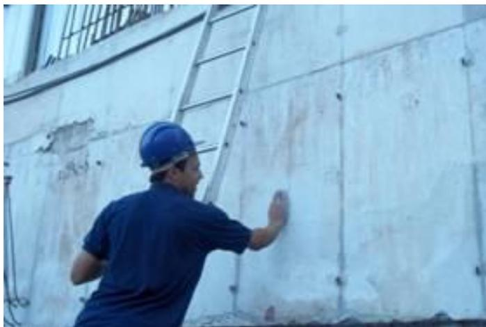
Figura 12: Lixamento da superfície antes da execução do ensaio na obra do Museu da Imagem e do Som (FONTE: O autor)
