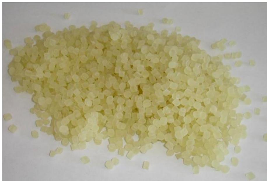
Figura 5: Pellets de blenda de polietileno com amido termoplástico (DEMM – UFRJ)
