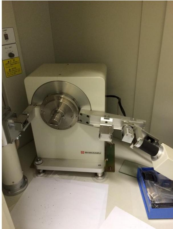
Figura 11: Máquina de difração de Raios-X modelo Shimadzu (COPPE/UFRJ)
