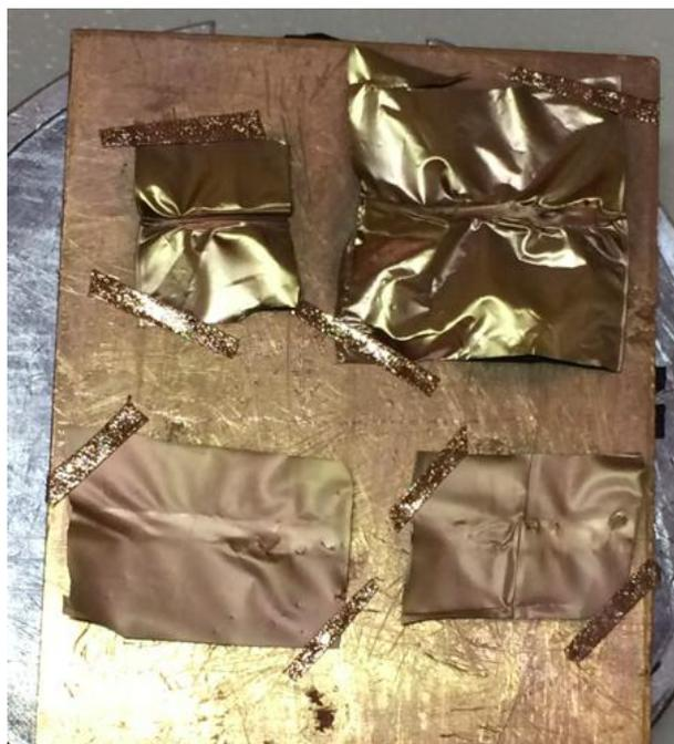
Figura 10: Corpos de prova recobertos com ouro (DEMM – UFRJ)
