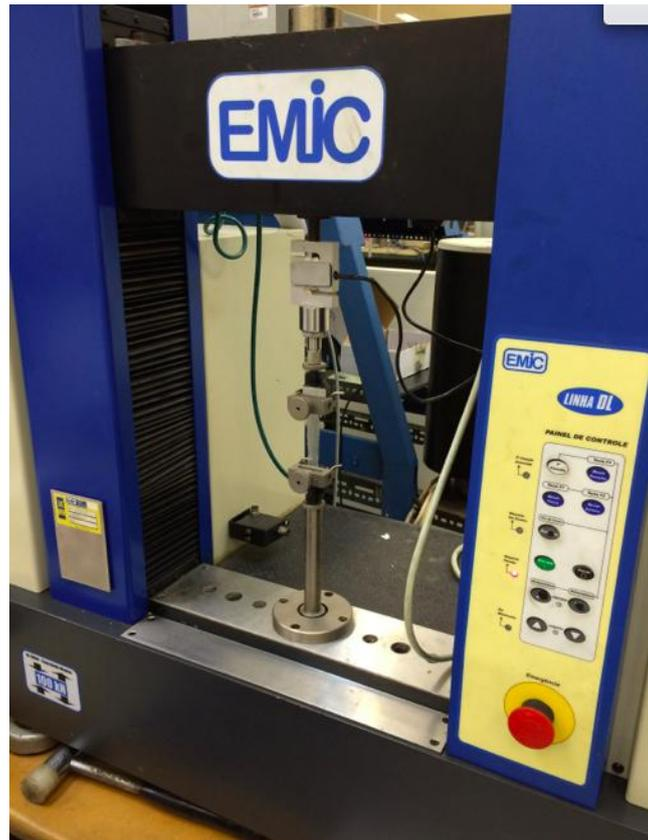
Figura 12: Máquina de ensaio de tração universal modelo Emic (Coppe/UFRJ)
