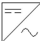
Figura 2.12 – Símbolo Elétrico do Inversor
