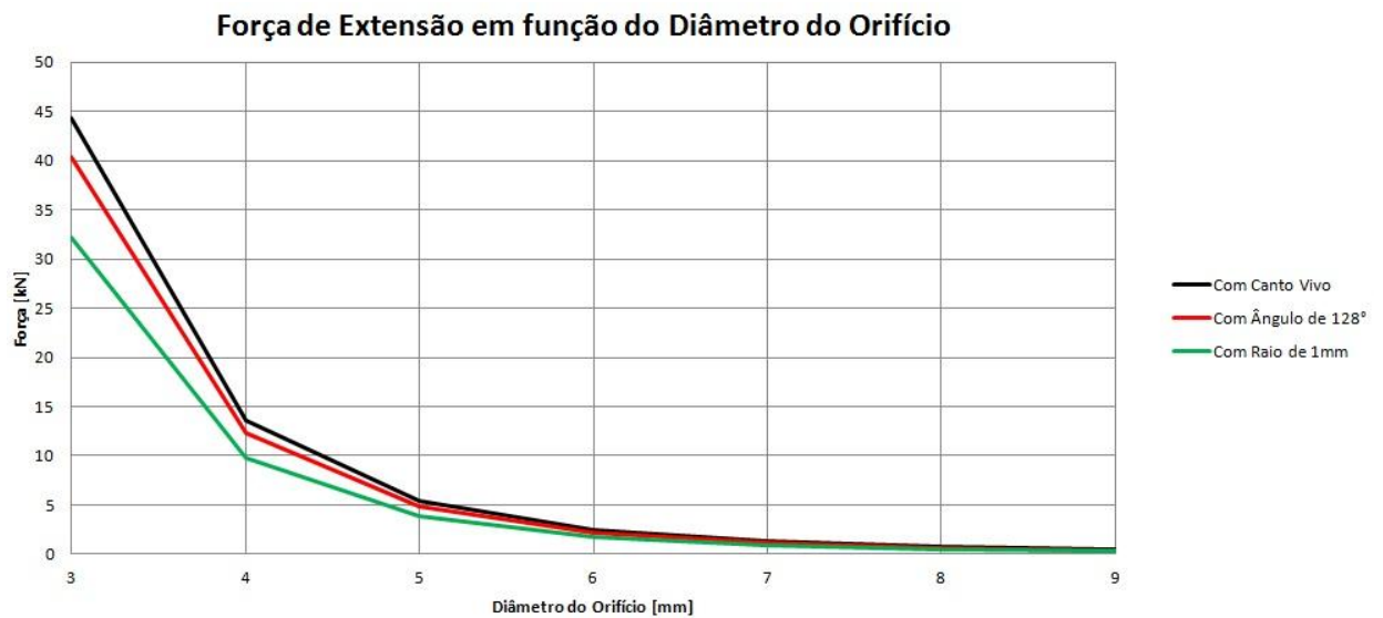
Figura 14 - Gráfico da Força de Extensão em função da Geometria do Orifício
