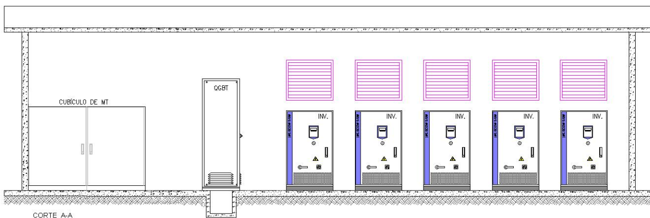
Figura 3.25 - Vista em corte da Sala dos Inversores apresentando em detalhe os equipamentos instalados
