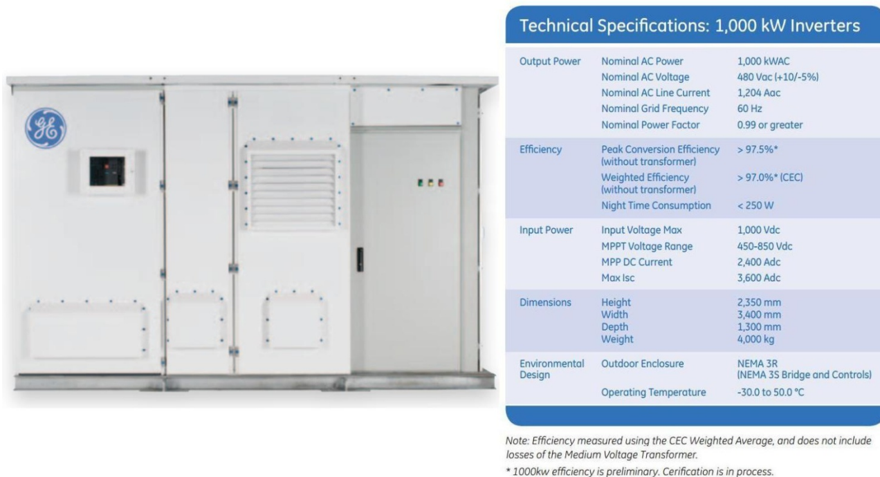
Figura 4.3 - Inversor GE - 1.000 kW e suas principais características técnicas [19]
