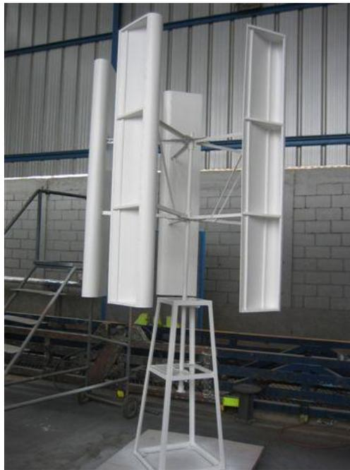
Figura A.1 - Protótipo da turbina Lenz
