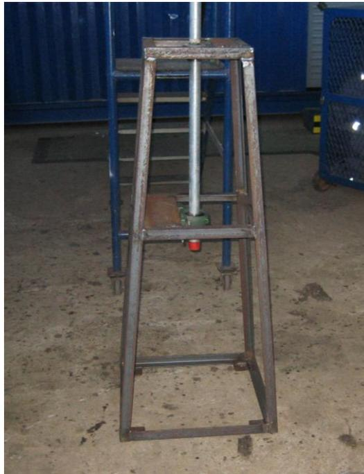
Figura A.7 – Torre de sustentação da turbina
