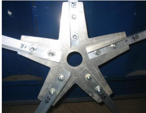
Figura A.4 – Suporte de fixação das pás
