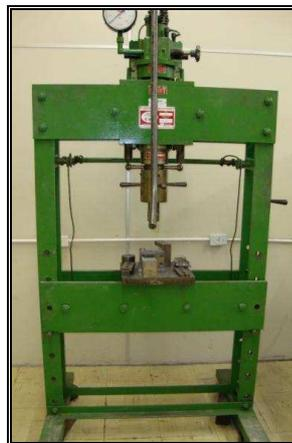
Figura 9. Prensa hidráulica uniaxial.
