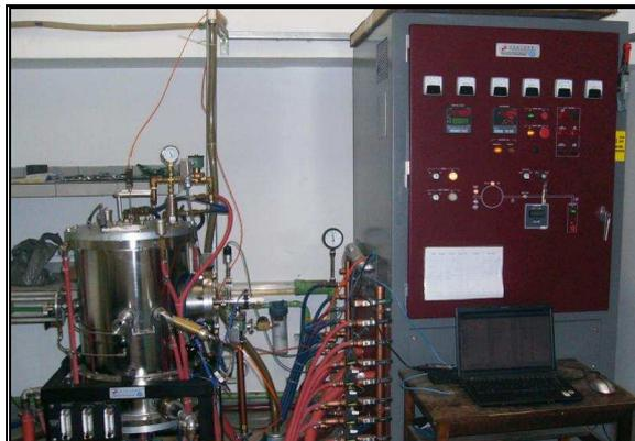
Figura 11. Forno de sinterização a vácuo.
