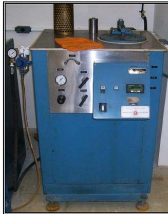
Figura 10. Prensa isostática a frio.
