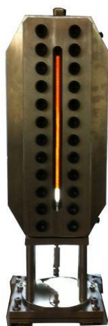
Figura 7 - Sistema utilizando a técnica de rising bubble apparatus - (Vinci Technologies) disponível em http://www.vinci-technologies.com/products-explo.aspx?IDR=82291&idr2=82572&IDM=536824
