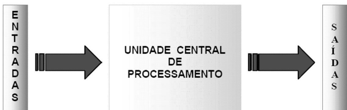
Figura 8: Estrutura básica de um CLP
