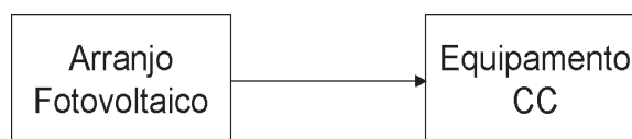
Figura 19: Sistema isolado com carga CC sem armazenamento (Fonte: Manual de Engenharia Para Sistemas Fotovoltaicos)
