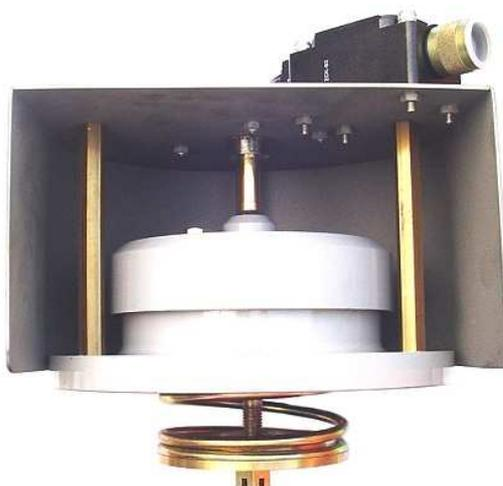
Fig. 6.1 – Válvula de alívio de pressão: corte
