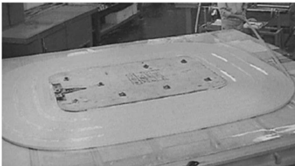
Figura 4.11 – Enrolamentos do tipo panqueca
