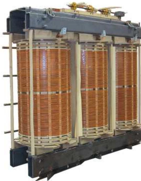
Figura – 4.3 – Montagem de um transformador de núcleo envolvido trifásico
