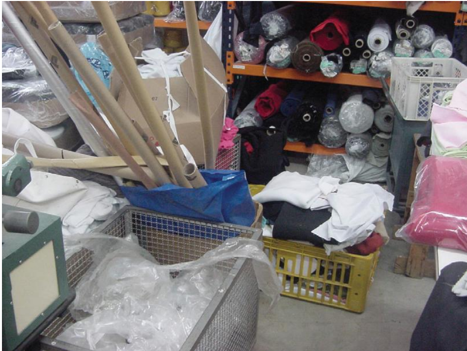
Figura 5: Resíduos típicos de confecção sem segregação. Fonte: Produção mais limpa em confecções (CNTL, 2007)
