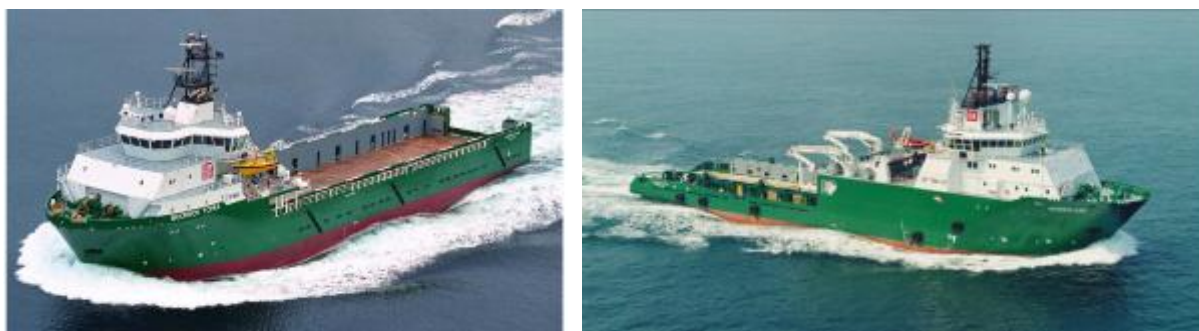
Figura 13 – A - Exemplo de embarcação do tipo PSV. B - Exemplo de embarcação do tipo AHTS. Fonte: Bourbon, 2014
