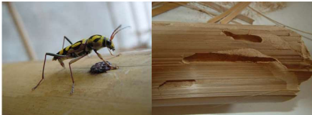
Figura 28 - Bambu atacado por inseto Chlorophorus annularis Site 25
