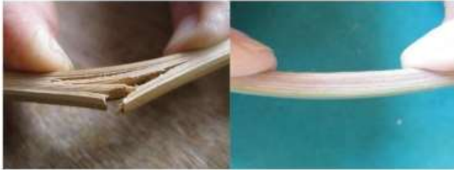
Figura 9 - Flexão estática do bambu. Casca para cima (esquerda) e casca para baixo (direita). Beraldo (2008)
