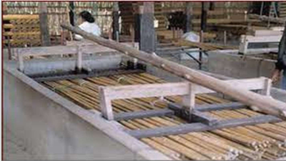
Figura 32 - Imersão de colmos de bambu em solução de boro ou cobre Apuana (2019)
