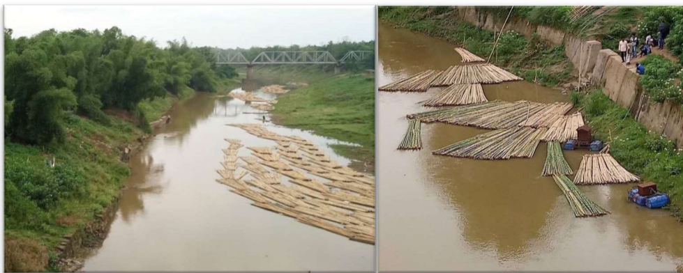
Figura 33 - Imersão dos colmos em água. Bambu Wiki (2019)
