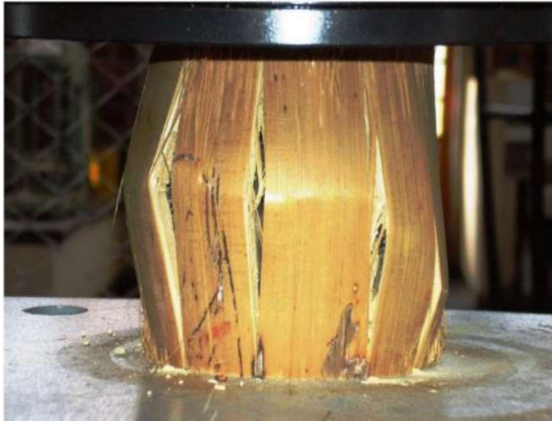
Figura 8 - Corpo de prova após rompimento Ghavami, K; Marinho, A.B. (2005)
