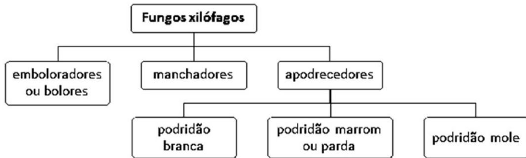
Figura 26 - Classificação dos fungos que atacam ao bambu. Kleine (2010) adaptado
