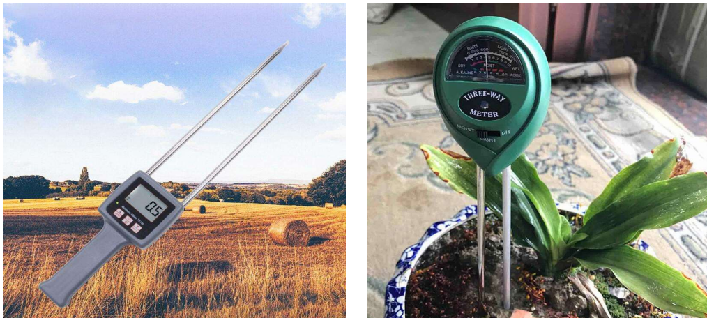
Figura 35 - Utilização de higrômetros resistivos Franke, Franke e Scharmacher (2013).
