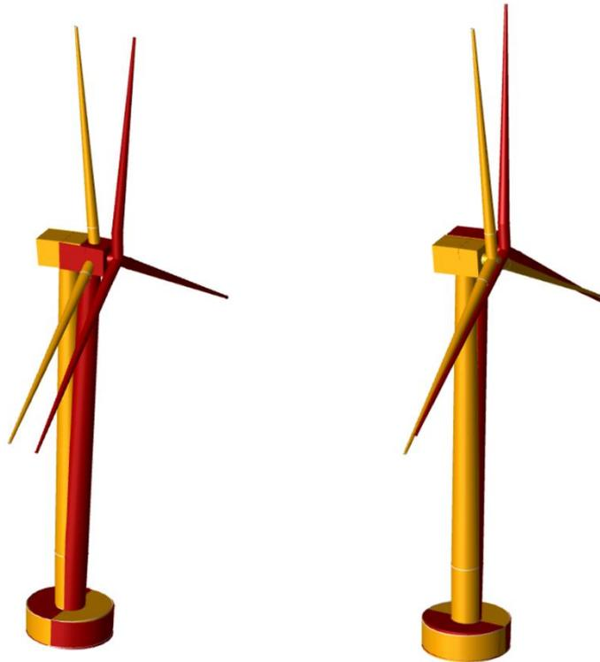
Figura 5-10 - Modelo SACS - Os 2 primeiros modos de vibração da torre eólica
