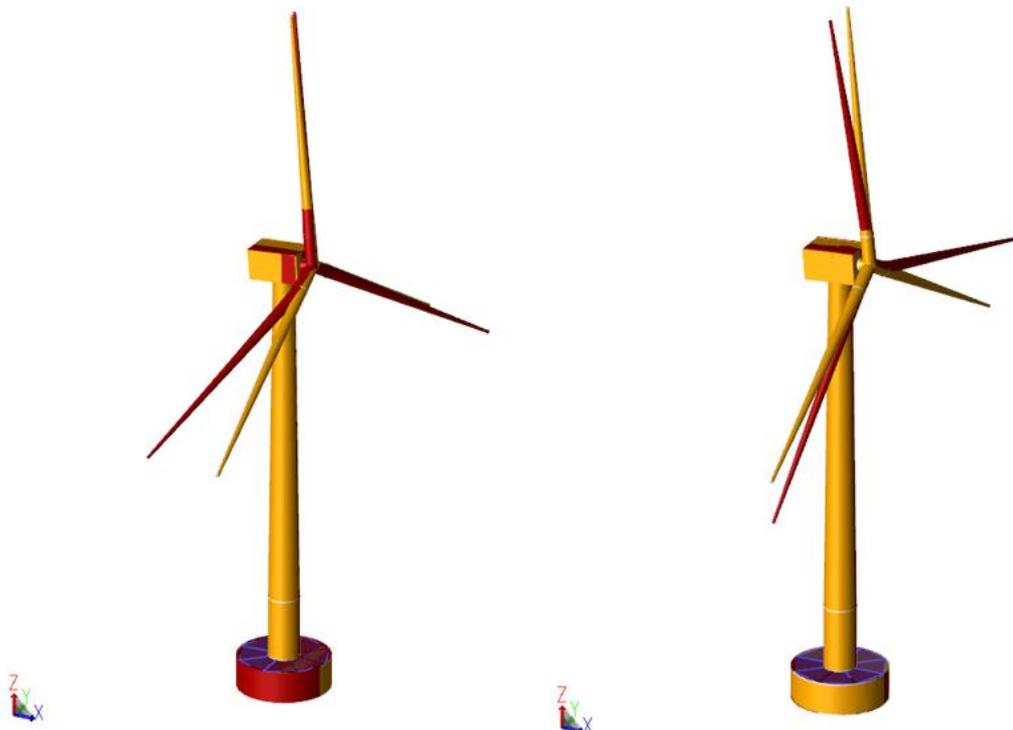
Figura 5-11 - Modelo SACS - Modos de vibração 3 e 4 da torre eólica
