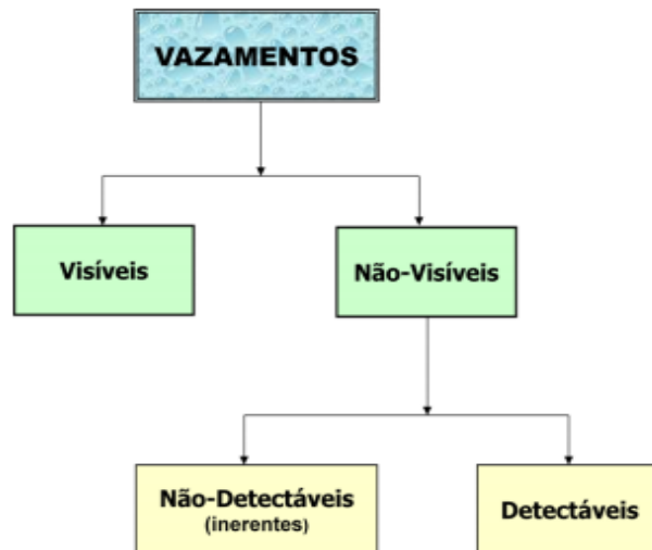
Figura 10 – Tipos de vazamento
